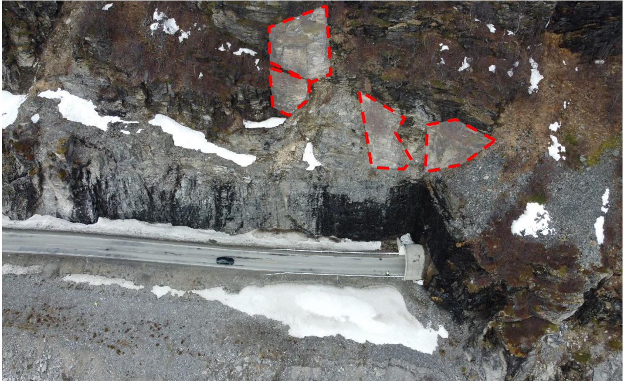
Foto 5 Påhugg og forskjæring ved Sortviktunnelen sør. Markerte områder viser areal som fremstår som ustabile og anbefales sikres. Detaljprosjektering av sikring må utføres etter rensk av ingeniørgeolog.
